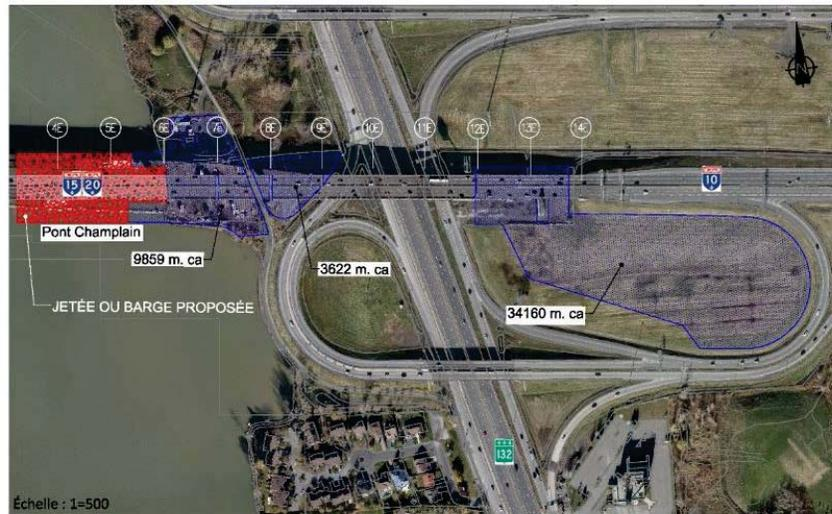
Figure 39 – Site de démantèlement et de manutention « C » et « D » – Brossard
